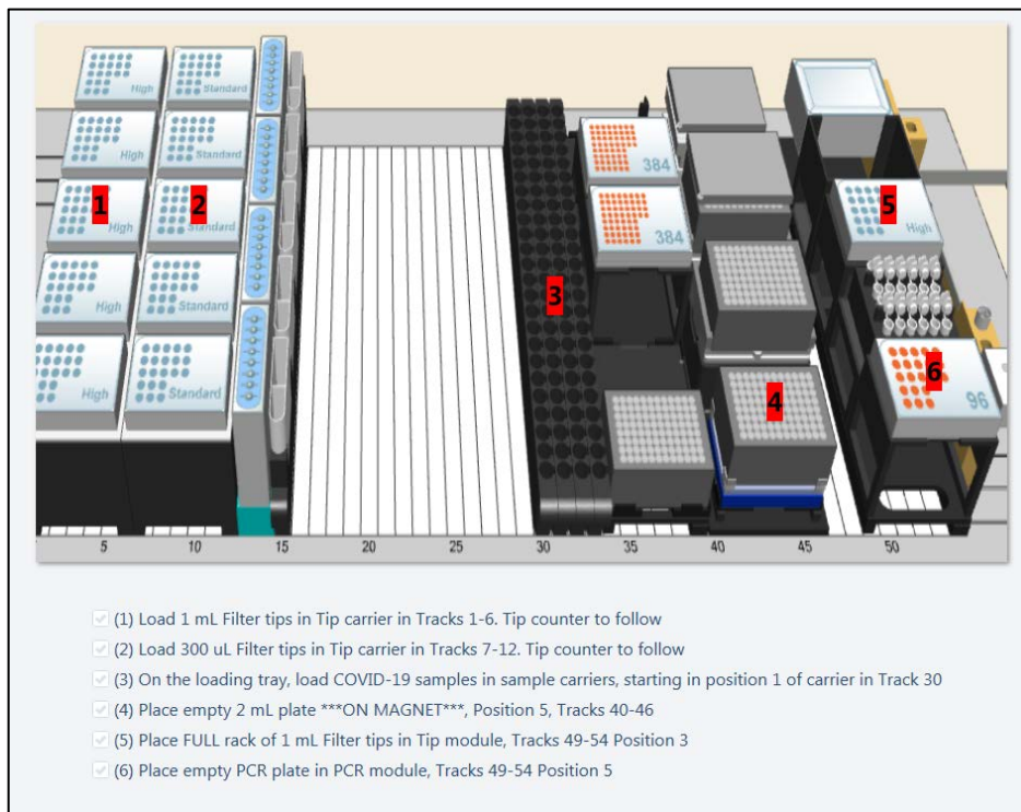
Figure 2. Schéma de disposition du plateau pour les consommables comme indiqué dans le logiciel GENFLEX™ Venus.
